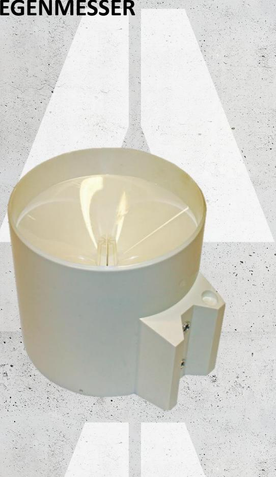
Der Mechanismus besteht aus einem Magnet, der sich an einem Reed-Kontakt vorbeibewegt und somit den Stromkreis öffnet oder schließt. Der Doppellöffel (Wippe) kippt nach links oder rechts und verliert durch eine sehr schnelle Schaltmechanik kein Wasser. Die Auflösung bei einer Fläche von  $200 \text{ cm}^2$  beträgt 0,2 mm, während die Auflösung bei  $80 \text{ cm}^2$  0,5 mm beträgt. Zusätzlich kann eine Heizung für den Regenmesser integriert werden.
