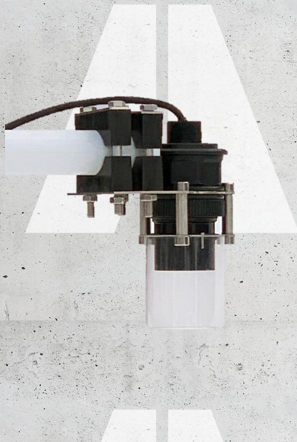
Der Ultraschall Schneehöhensor wird zur berührungslosen Messung der Schneehöhe unter extremen Bedingungen mit Ultraschallsensoren eingesetzt. Der Sensor zeichnet sich durch hohe Betriebssicherheit, einen geringen Energieverbrauch und einfache Handhabung im Feld aus.
