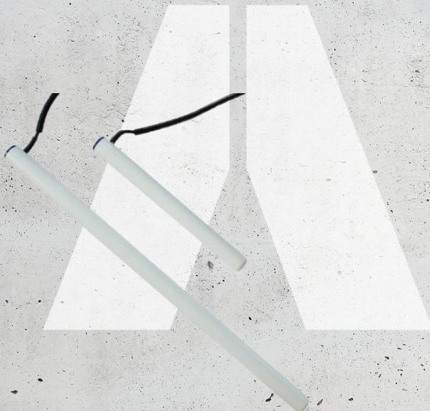
Die Sentek Drill & Drop Sonde bietet dem Anwender eine große Flexibilität bei der präzisen Überwachung von Temperatur, Wasser und Salzgehalt (Triscan) in mehreren Tiefen eines Bodenprofils. Erhältlich in den Längen: 30 cm, 60 cm, 90 cm und 120 cm, mit Sensoren, die im Abstand von 10 cm befestigt sind.
