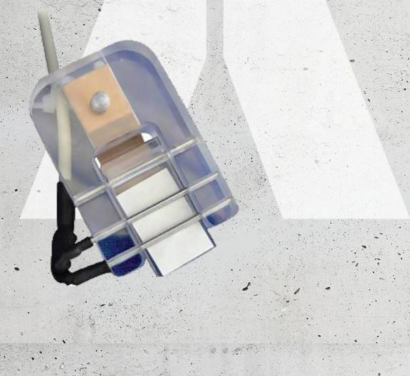
Der Blattnässesensor misst die Leitfähigkeit in einem Filterpapier. Das Filterpapier wird zwischen zwei Edelstahlelektroden in einer transparenten Halterung gehalten. Die Verwendung von transparentem Lucite-Kunststoff als Halterung reduziert das Aufwärmen des Sensors, wenn er direktem Sonnenlicht ausgesetzt ist.
